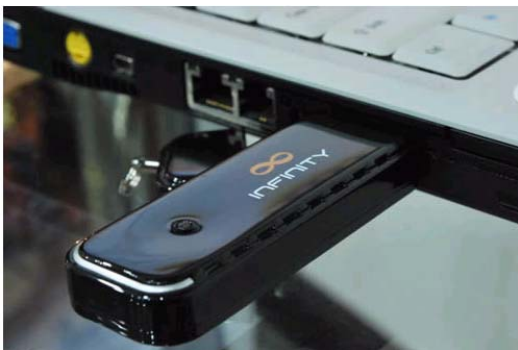
รูป 3.14 การใช้ Air card ต่ออินเทอร์เน็ต
