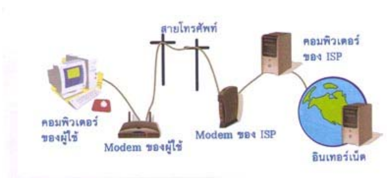
รูปที่ 3.12 การใช้ Dial up modem ต่ออินเทอร์เน็ต
