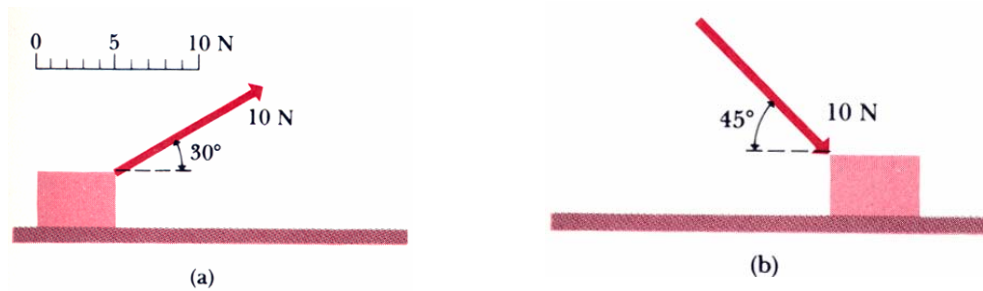
รูป 4-2 แผนภาพแทนแรงที่กระทำบนกล่อง
